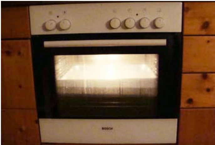
REPARIERT: Backrohrlicht, jedoch keine Heißluftfunktion mehr
